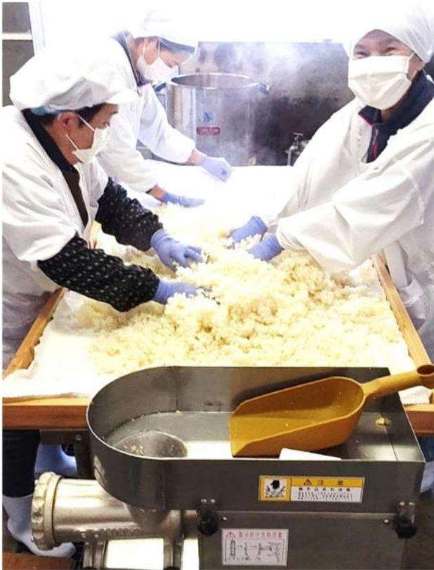
一回の仕込み作業には三日かかります。まず麴造りから始まり、圧力釜でやわらかく仕上げた大豆に麴、塩を加えてよく混ぜ合わせます。これをすりつぶすミンサー（手前の機械）に通して大きな桶に移します。12月まで熟成させる
